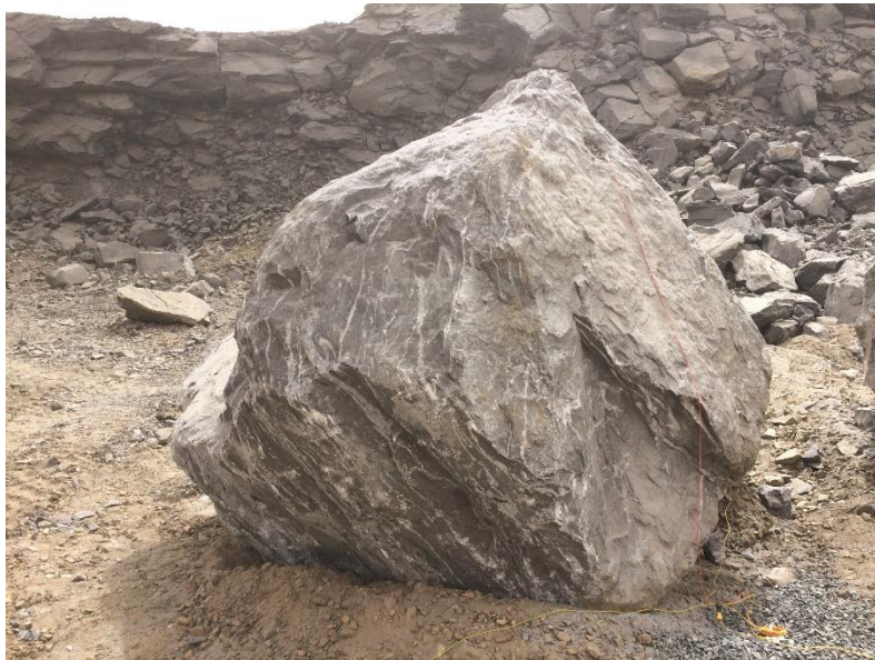
Figura 19 - Imagem ilustrativa da geração de blocos pós desmonte com granulometria superior à boca de alimentação do britador
